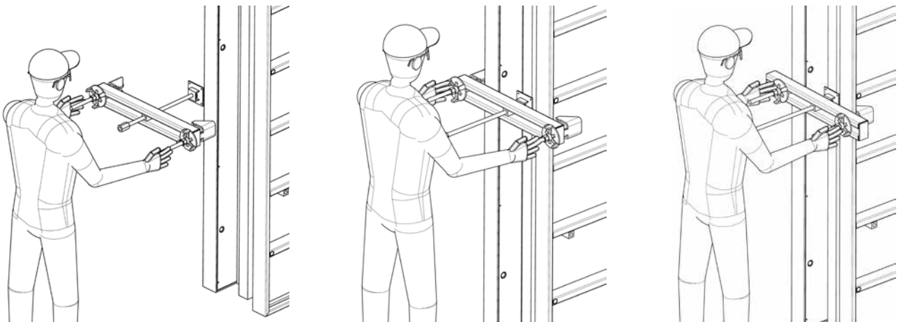
Fig. 43 : Mise en place des traverses d'about
