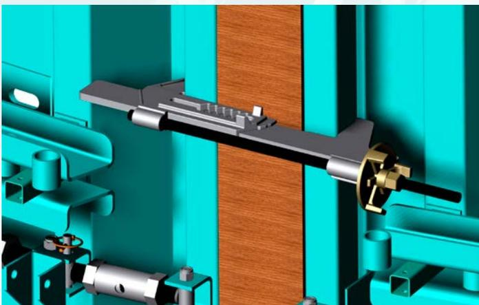
Utilisation de la serrure réglable PERFORM / FLEXEL pour l'assemblage avec fourrure jusqu'à 25 cm.
