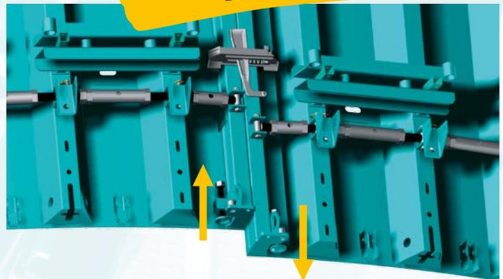
Les bandes FLEXEL, une fois cintrées, seront assemblées **centrées selon le même axe** : les éléments de 2,32 m à l'intérieur, les éléments de 2,40 m à l'extérieur.
