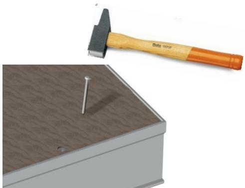
Pour la fixation d'accessoires sur les panneaux tels que boîtes ou réseau électriques, est autorisé l'utilisation d'agrafes ou de clous maxi 60mm ou 3 mm de diamètre. Il est recommandé d'utiliser au maximum les mêmes panneaux dans les zones de clouage lors des différentes phases afin d'en préserver le maximum.
