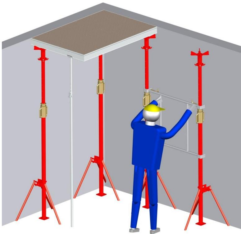
Pour le positionnement régulier des étais on peut utiliser un écarteur pour leur maintien en place, il est déplacé au fur et à mesure de l'avancement
