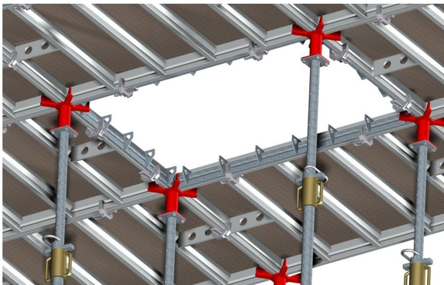
Gestion d'une descente de gaines techniques, la zone est remplacée par un contreplaqué ep: 16mm de la dimension de l'élément et posé sur les profils de correction
